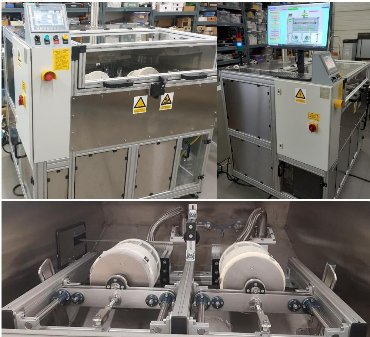
Stroj je izrađen od aluminijskih profila i nehrđajućeg čelika jer vrši sušenje mokrih komponenti koje su prije ovog procesa bile ispiranje DEMI vodom.
