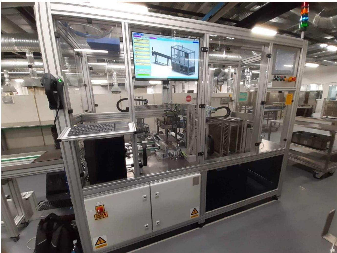
“KOTRA – PS01” je stroj za automatsko transportiranje, izbijanje i slaganje električnih komponenti na rešetke. Krajnji proizvod su rešetke u strogu spremni za daljnju obradu. Aktuatori: električne osi, pneumatski cilindri, hidraulički cilindar, pokretnе trake.
