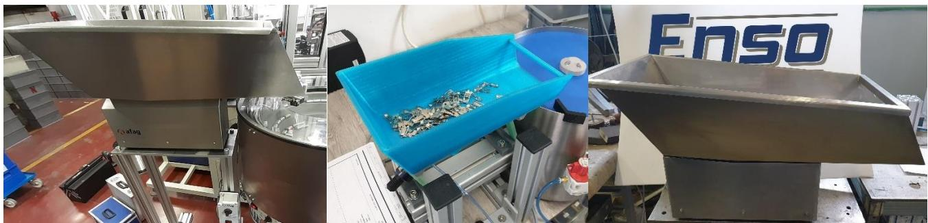
**Kružni vibrododavač** je uređaj koji dozira rasute materijale ili izdvaja, pozicionira i vodi u niz proizvodne komade da bi se njima manipuliralo na željeni način. Elementi ili dijelovi dolaze na izlaz kružnog dodavača orientirani na željeni način i pogodni za uzimanje ili izdvajanje.
