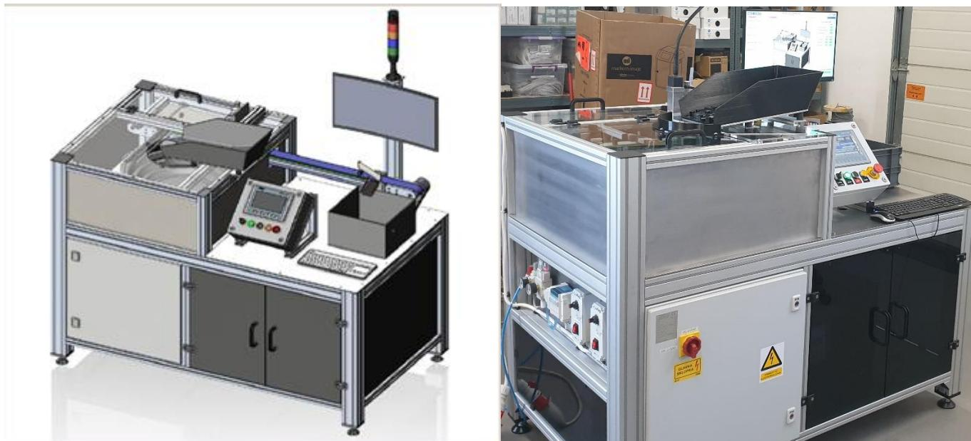
1. Upravljački dio – Upravljanje strojem izvedeno je PLC-om. Odgovarajućim softverom i dodatnim modulima upravlja se aktuatorima. Komunikacija operatera i stroja izvršena je pomoću HMI panela, tipkala i SCADA sustava.
