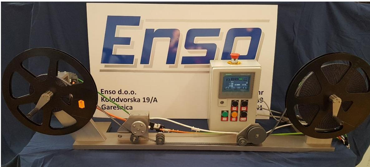
PREMKO je stroj za prematanje kolutova s mogućnošću pozicioniranja na željeni komad u traci koluta.
