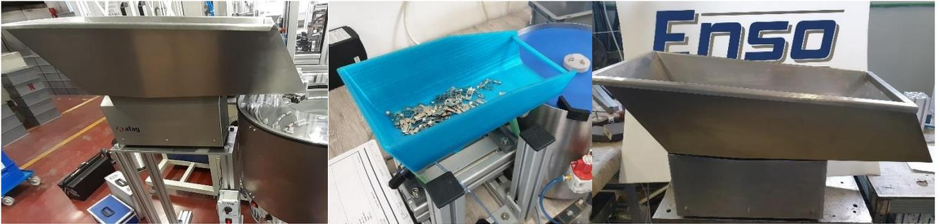
Ein **Wendelförderer** ist ein Gerät, das Schüttgüter dosiert oder in eine Reihe von Produktionsstücken trennt, positioniert und führt, um sie auf die gewünschte Weise zu manipulieren. Elemente oder Teile kommen am Ausgang des Wendelförderers in der gewünschten Weise orientiert und zum Entnehmen oder Entnehmen geeignet.
