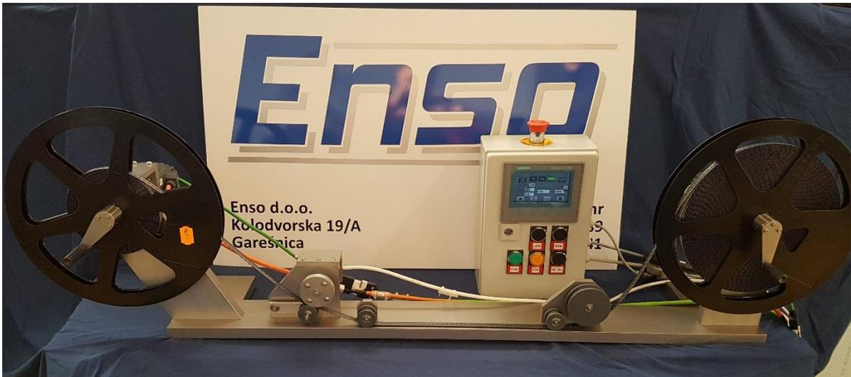
PREMKO ist ein Rollenwickler mit der Möglichkeit, auf dem gewünschten Stück in der Rollenstange zu positionieren.
