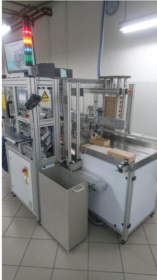
Konstruktion und Bau der BRIZ-Maschine zum Brechen, Zählen und Verpacken der enthaltenen elektronischen Komponenten:
