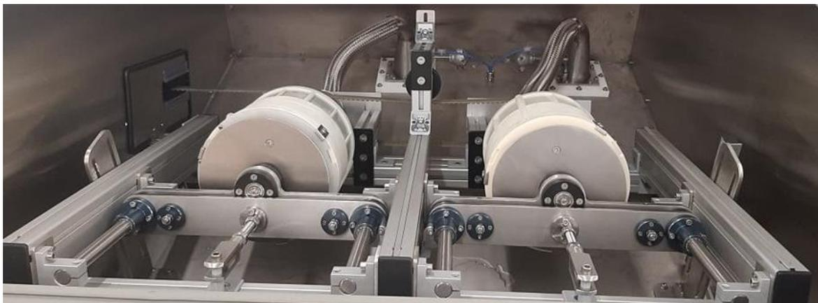
Die Maschine besteht aus Aluminiumprofilen und Edelstahl, weil sie nasse Bauteile trocknet, die vor diesem Prozess mit DEMI-Wasser gewaschen wurden.
