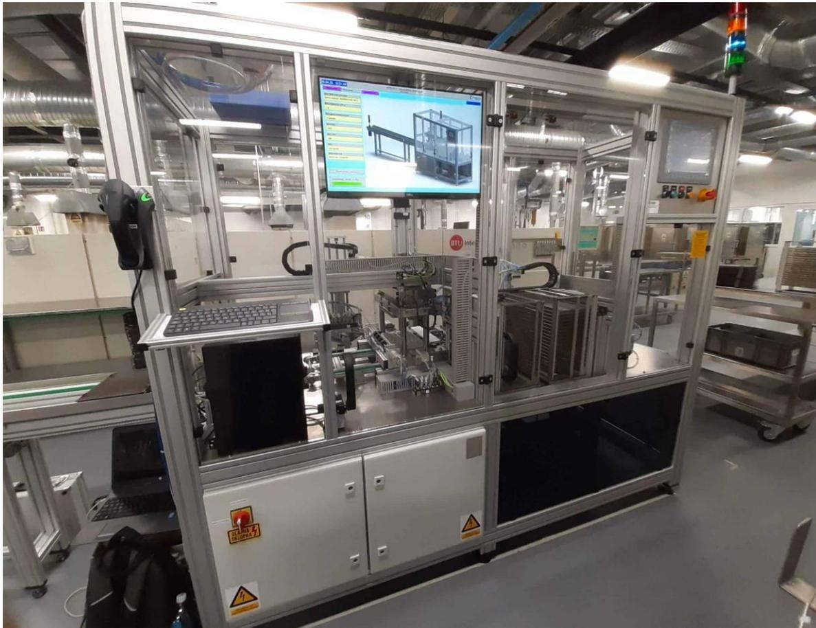
"KOTRA - PS01" ist eine Maschine zum automatischen Transport, Auswerfen und Stapeln elektronischer Komponenten im Netz. Das Endprodukt sind Gitter, die zur weiteren Verarbeitung bereit sind.
