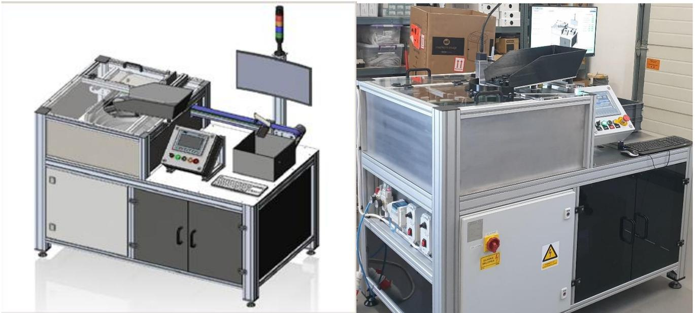
1. Steuerung – Die Maschine wird von einer SPS gesteuert. Entsprechende Software und Zusatzmodule werden über Aktoren gesteuert. Die Kommunikation zwischen dem Bediener und der Maschine erfolgte über das HMI-Panel, die Tasten und das SCADA-System.
