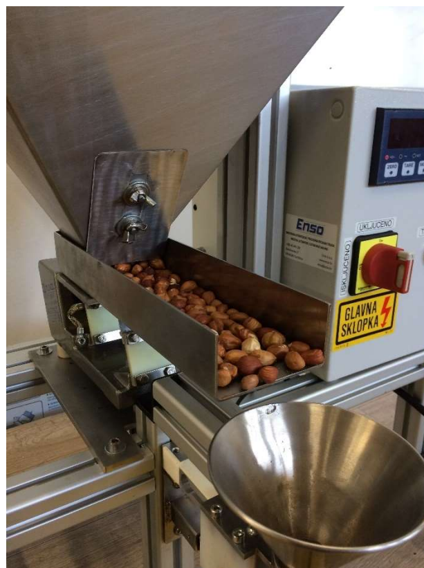
Slika 6. Sustav transporta i raspodjele materijala
